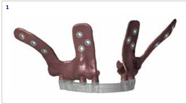
Afb. 1 'Reversed engineering'. Prothetisch gedreven digitaal ontwerp van een AMSJI, op basis van CBCT-data van een dual scan met scanprothese.
